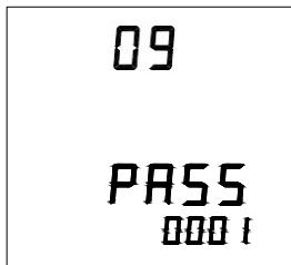
自此已完成了系統參數設定，同時按下“H”鍵和“V/A”，退出設定模式進入測量參數顯示模式。
