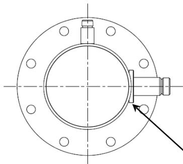
底座在焊接前都要採用線切割加工成與管道外徑相同的圓弧以確保焊接的密封性
